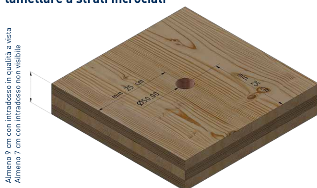
Movimentazione orizzontale di legno lamellare a strati incrociati
