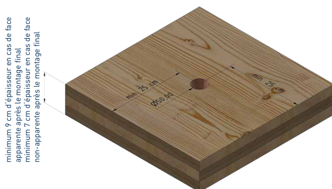
Manipulation horizontale de bois contrecollé
