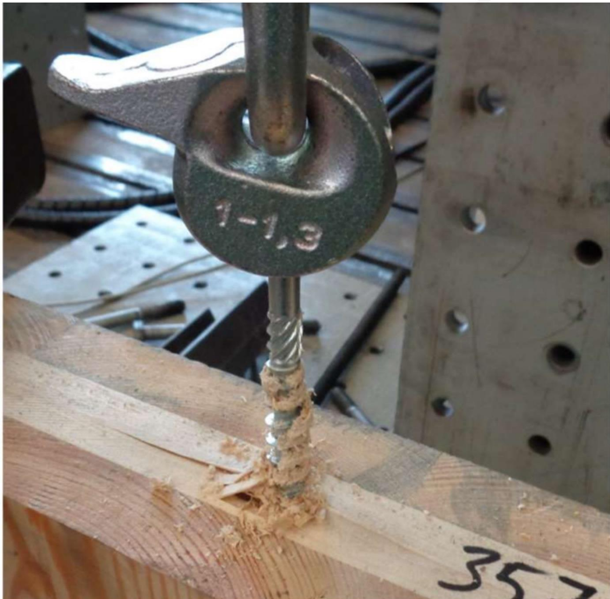
Abbildung 8: Ausgerissenes Gewinde (Quelle: Sihga GmbH)
